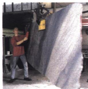
Heben? Mit Köpfchen und mit maschinellem Hilfsgerät ist das einfach, auch ohne Bärenkräfte.
